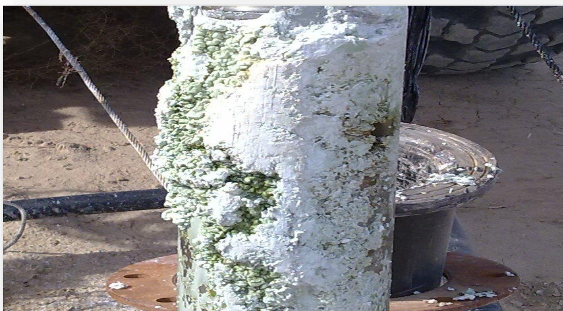
Рисунок 3.1 - Осадкообразования из внутренних поверхностей погружных насосов откачных скважин [15]
