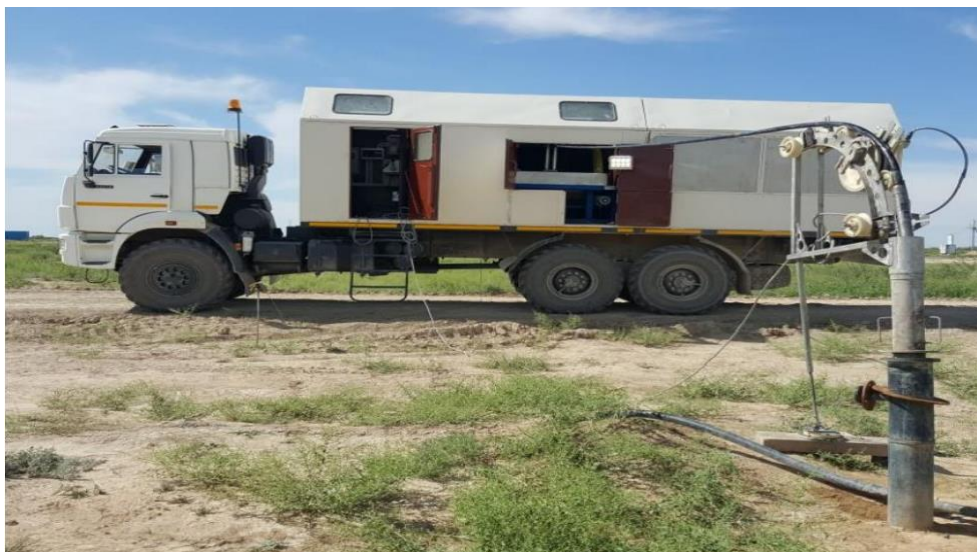
Рисунок 6.1 - Установка химической обработки фильтровой части скважин [19]
